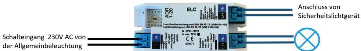
Der Überwachungsbaustein ELC-DALI dient der Realisierung des Mischbetriebs und der Einzelleuchtenüberwachung. Die Zuordnung aller Betriebsarten erfolgt – ohne Eingriff in die Leuchteninstallation – durch das Steuerteil. Die DALI- bzw. DIM-Steuerung werden im Notlichtbetrieb unterbrochen und Bereitschaftsleuchten auf dem DALI-EVG eingestellten Notlichtwert eingeschaltet.
