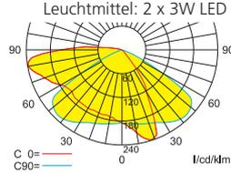
Lampenlichtstrom Not/Netz: 480lm/360lm – Nennbetriebsdauer: 1h/3h
