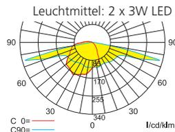
Lampenlichtstrom Not/Netz: 240lm/360lm – Nennbetriebsdauer: 8h
