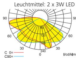
Lampenlichtstrom Not/Netz: 240lm/360lm – Nennbetriebsdauer: 8h
