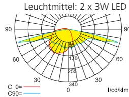
Lampenlichtstrom Not/Netz: 480lm/360lm – Nennbetriebsdauer: 1h/3h
