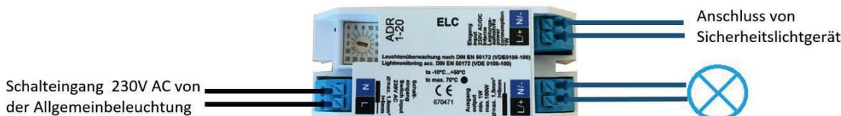
Der Überwachungsbaustein ELC-DALI dient der Realisierung des Mischbetriebs und der Einzelleuchtenüberwachung. Die Zuordnung aller Betriebsarten erfolgt – ohne Eingriff in die Leuchteninstallation – durch das Steuerteil. Die DALI- bzw. DIM-Steuerung werden im Notlichtbetrieb unterbrochen und Bereitschaftsleuchten auf dem DALI-EVG eingestellten Notlichtwert eingeschaltet.
