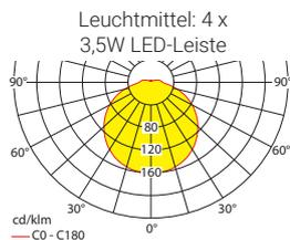
Lampenlichtstrom Not (DC) / Netz: 330lm/1160lm – **Nennbetriebsdauer: 8h**
