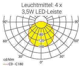
Lampenlichtstrom Not (DC) / Netz: 660lm/1160lm – **Nennbetriebsdauer: 3h**
