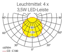
Lampenlichtstrom Not (DC) / Netz: 660lm/1160lm – **Nennbetriebsdauer: 1h**
