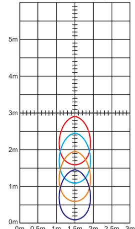
Mit min. 5lx angestrahlte Fläche bei Leuchtenhöhe(Lh)
