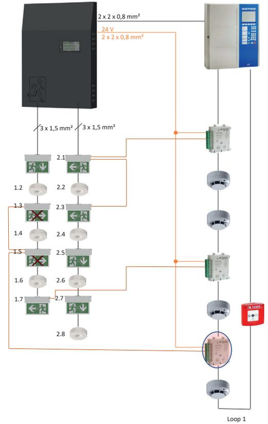
**Anschlusschema (Beispiel): RIVA-Leuchten in Verbindung mit Brandmeldeanlage und CPS/LPS**
